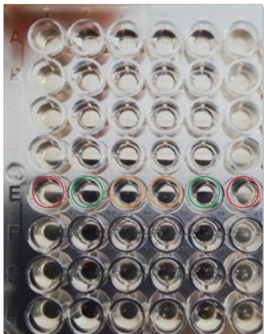
Рис. 1.1. Учет результатов определения чувствительности мицелиальных грибов с использованием фона с чередующимися черными и белыми полосами нет роста микроорганизмов – четкая граница между черным и белым цветом (ячейка, обведена зеленым цветом); слабый рост (ячейки, обведенные оранжевым цветом); видимый рост (ячейки, обведенные красным цветом).
