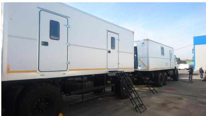
Это полноценные ПЦР лаборатории, оснащенные боксами 2 уровня биологической защиты, автономным энергоснабжением, необходимым комплектом расходных материалов, способные в полевых условиях выполнять полный спектр лабораторных исследований на особо опасные инфекции, работать автономно и в качестве прикомандированных стационарных лабораторий при медицинских учреждениях в очагах инфекционных заболеваний.
