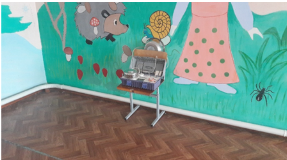
Рисунок. 2. Измерение потока радона от стены помещения мини-центра школы (1-й этаж)
